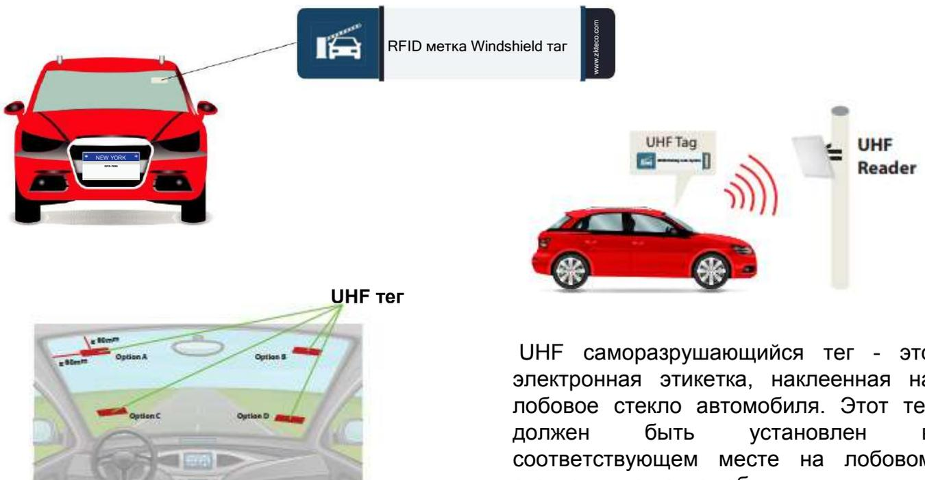
Расстояние между UHF-тегом и металлическим каркасом должно быть не менее 80 мм, рекомендуемые места установки приведены на рисунку выше.
